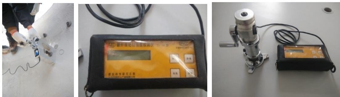
图 6 CFRP 拉拔试验粘结强度测试仪器
