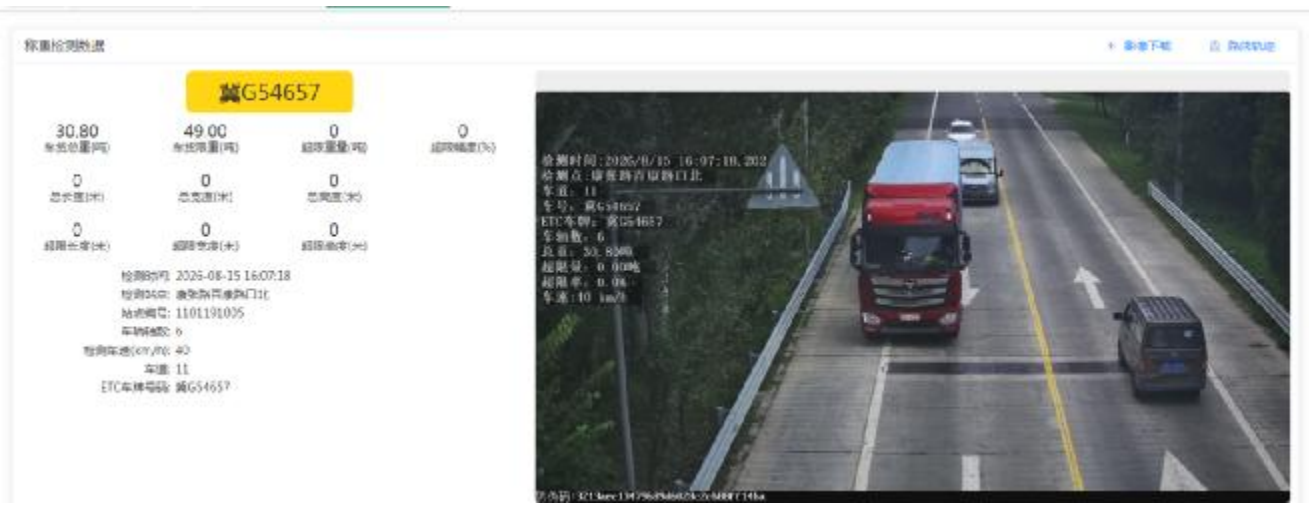
图 3-4 压线行驶逃避检测情况 4
