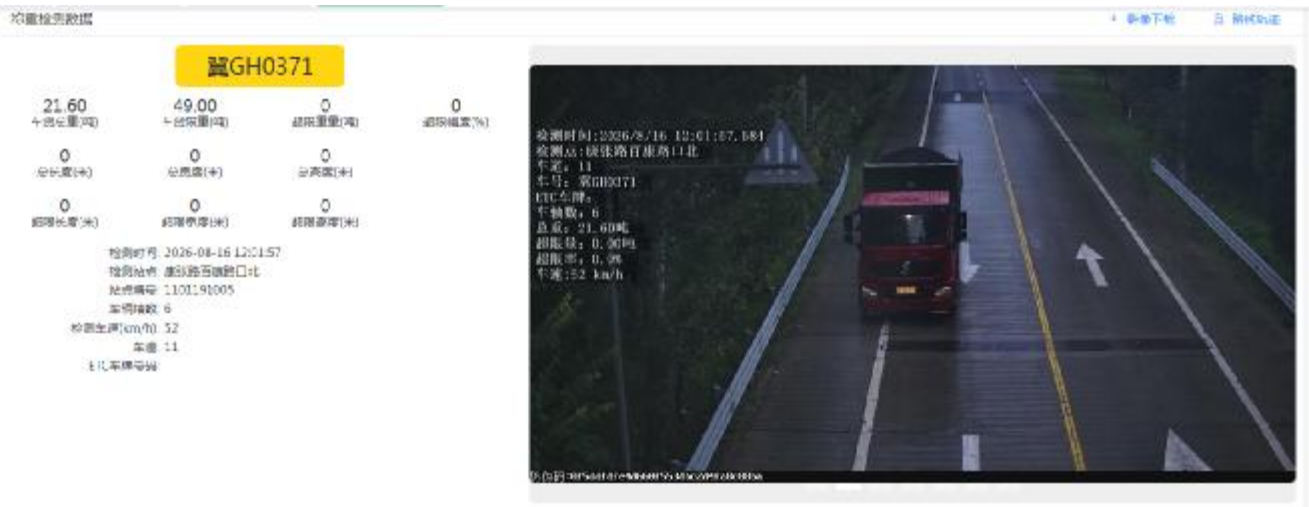
图 3-3 压线行驶逃避检测情况 3
