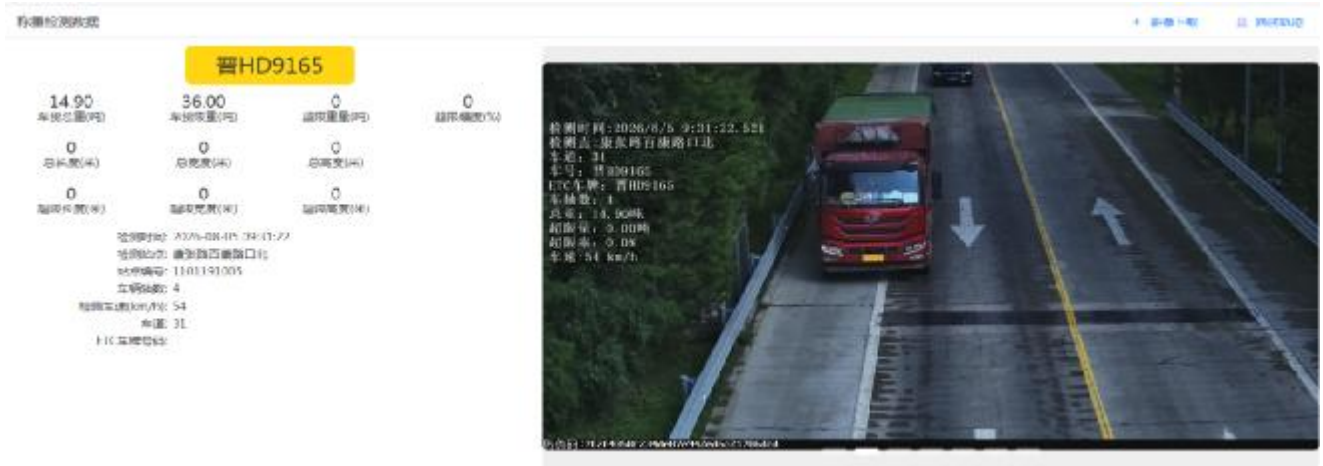
图 3-1 压线行驶逃避检测情况 1
