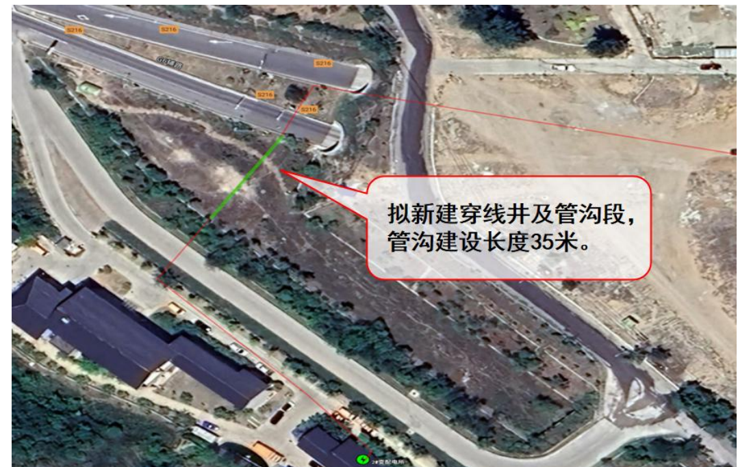
图 2-1-12 青龙桥隧道 2#变电所电缆路径示意图
