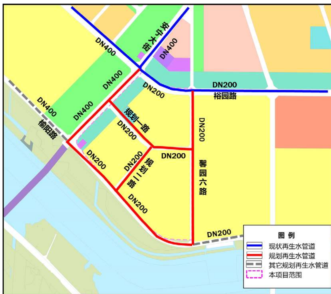
图 2-6 项目所在区域再生水管线规划示意图
