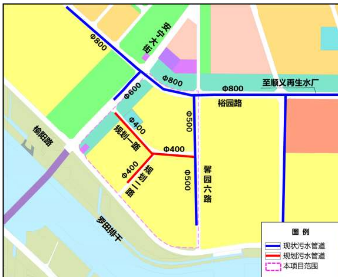
图 2-8 项目所在区域污水管线规划示意图
