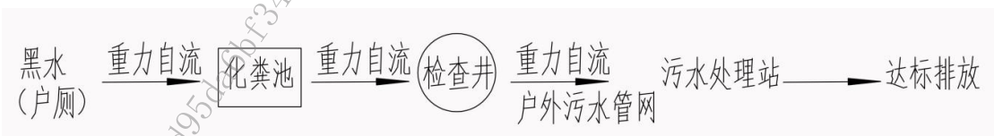
图3.2-1 重力排水管网系统
