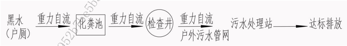
图3.2-1 重力排水管网系统
