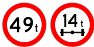
图 1 限制质量（左）、限制轴重（右）标志版面示例
