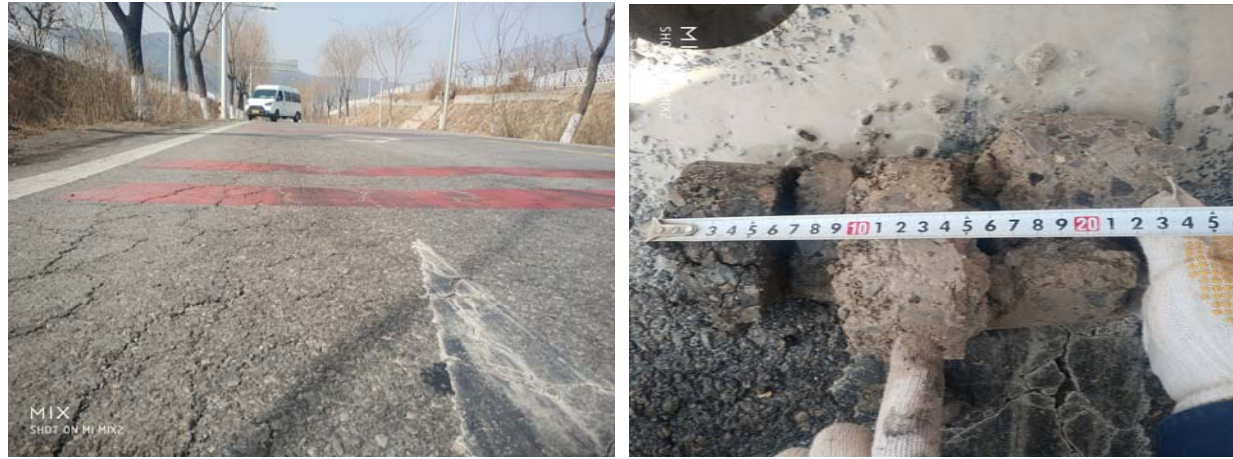
（4）逆桩 K24+890 完好处：取芯深度约 30cm，沥青面层厚度约 10cm，基层厚度约 20cm，沥青面层及基层完整性较好，基层结构强度足够。
