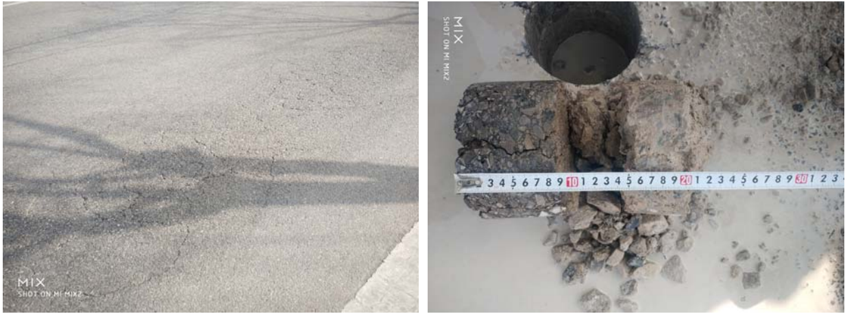
（3）顺桩 K24+625 龟裂处：取芯深度约 20cm，沥青面层厚度约 9cm，裂缝已贯穿整个结构层，基层完整性较差，松散较为严重。
