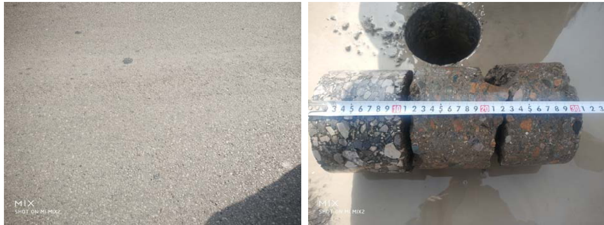
通过病害调查统计，车行道总面积约 29905m 2 ，病害面积约 8678m 2 ，占总面积的 29.02%。主导病害以变形类为主，其中车辙面积约 5841m 2 ，占病害面积 67.31%，龟裂伴沉陷面积约
